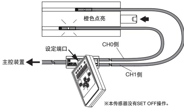
也可以向DP、DN直接供给24V电源来进行示教。(调试工作模式)
