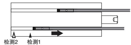
⑦ 请将ASLINKSENSOR固定在橙色LED点亮位置（检测1、2）的中间。
